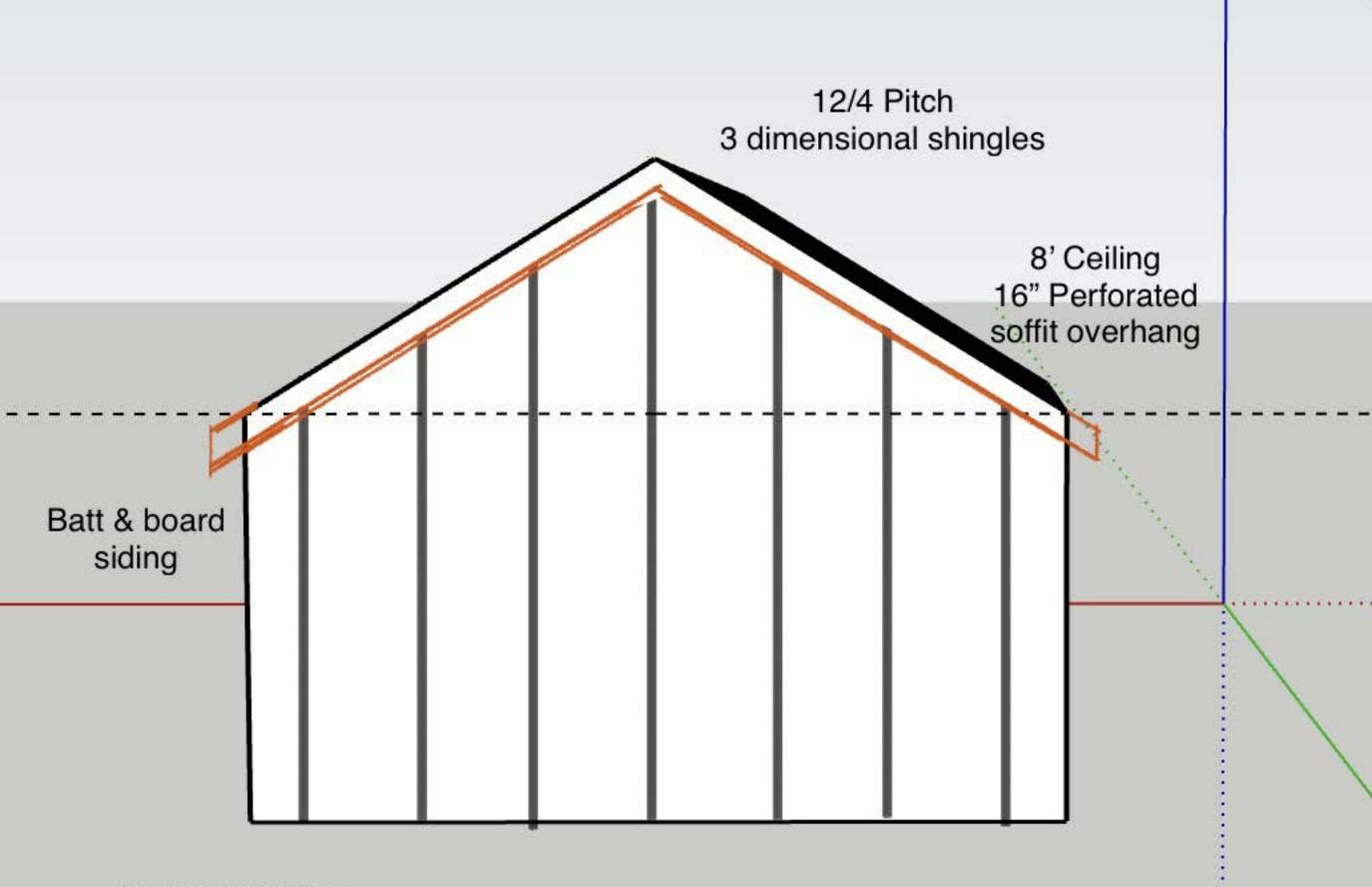
16 " O.C STUDS 16" O.C CEILING JOIST 24" O.C RAFTERS
